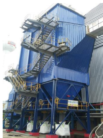
ภาพที่ 2.2-4 ระบบ ESP บริเวณปล่อง Biomass
